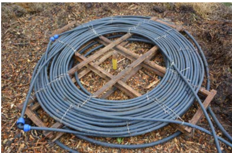
Afbeelding 3 en 4: benutten van condensatiwarmte in biomeiler, waterdamp en warmtewisselaar voor aftap condensatiwarmte (Bajko, 2019)
